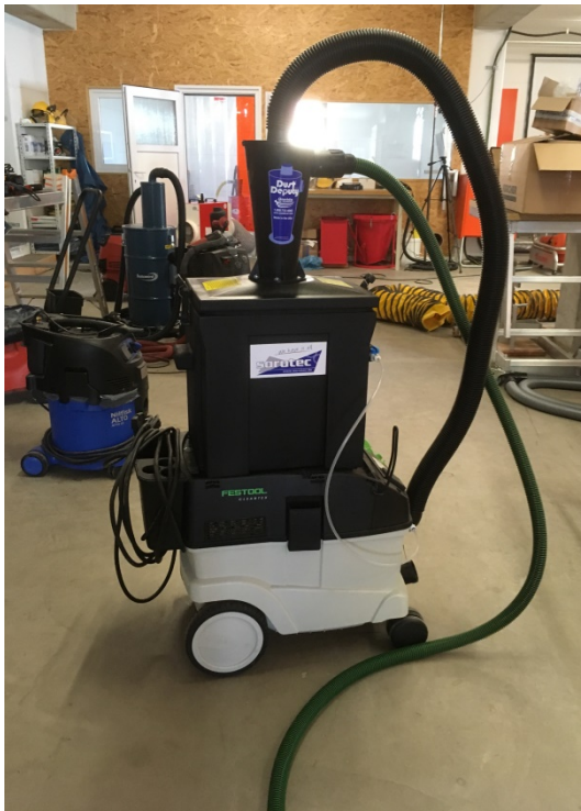
Abbildung 3: Entstauber mit aufgesetztem und separatem Vorabscheider
